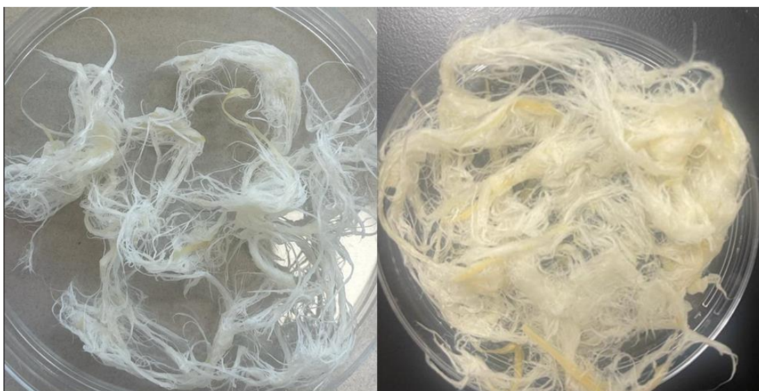
Figura 4.12: Fibras obtidas pelos caules cortados primários (NaOH 1M), à esquerda, e secundários (NaOH 0,5 M), à direita.
