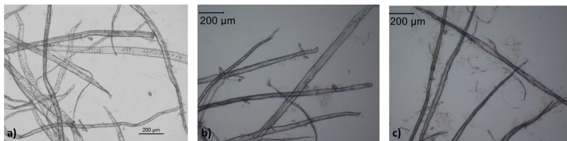
Figura 4.16: Análise microscópica das fibras softwood com o aumento da refinação.
