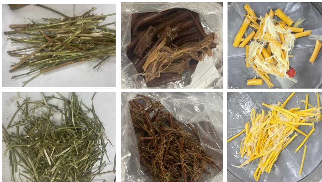
Figura 4.11: Processos de obtenção das fibras de cânhamo.
