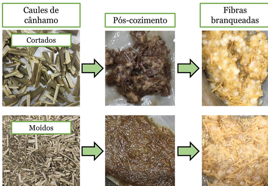
Figura 4.3: Etapas realizadas para a obtenção das fibras de cânhamo.
