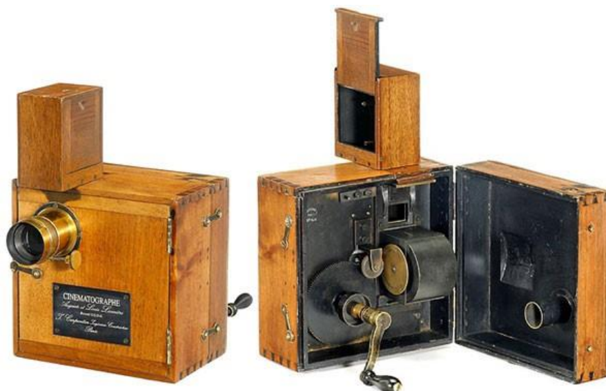
Figura 11 - Cinematógrafo, com visão do mecanismo interior.
