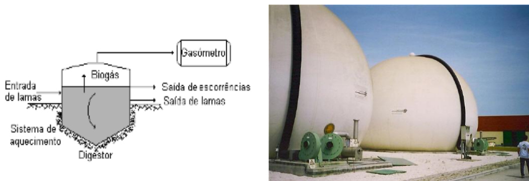
Figura 2.14: Digestor anaeróbio para estabilização de lamas: representação esquemática e aspeto geral (Albuquerque, 2008)
