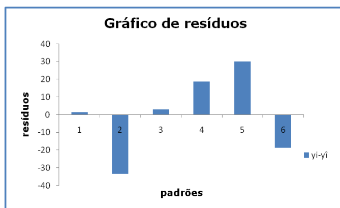
Figura II.18- Representação gráfica dos resíduos da recta de calibração do níquel.
