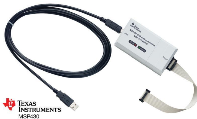
Figura 4.9. Fotografia do FET debugger MSP-FET430UIF.
