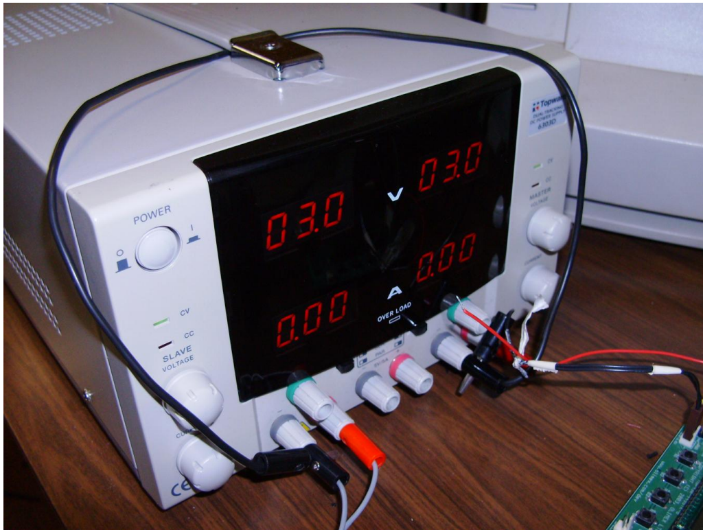
Figura 4.17. Fonte de alimentação em modo de 2 fontes independentes.
