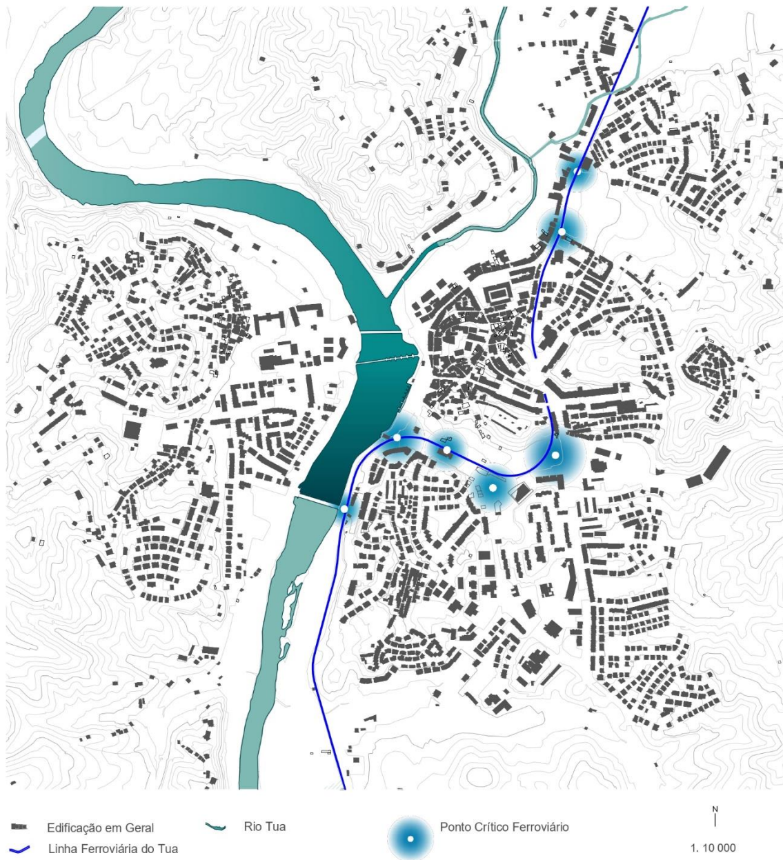
Figura 17 - Planta de pontos críticos ferroviários
