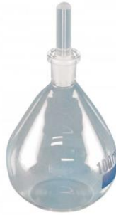
Figura 2.6 - Exemplo de um picnómetro para determinação da densidade das partículas sólidas
