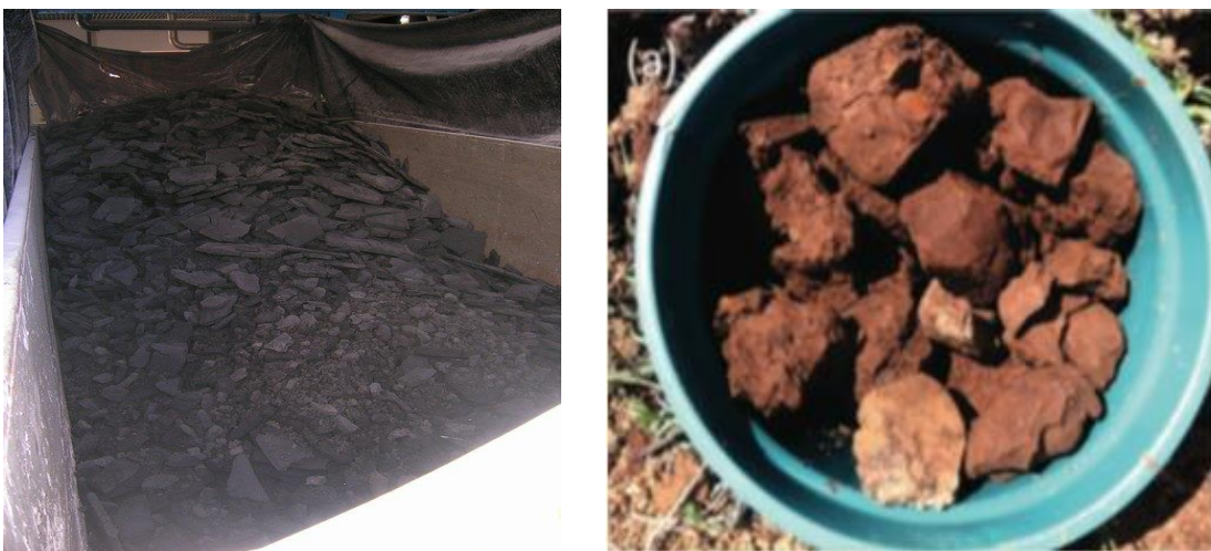
Figura 1.1 - Lama de ETA de decantador: a) com adição de carvão ativado; b) sem adição de carvão ativado
