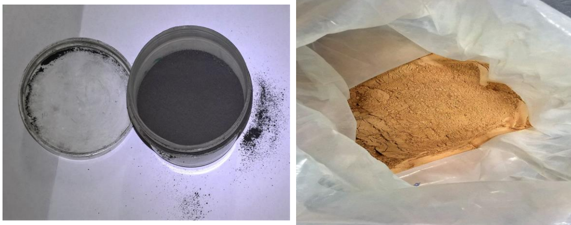
Figura 4.2 - RETA da ETA do Caldeirão: a) em bruto; b) após calcinação
