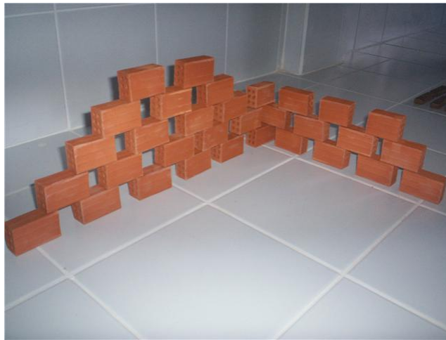
Figura 2.5 - Tijolos ecológicos com adição de RETA
