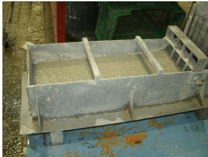
Figura 3.18- Fim do movimento do betão na Caixa L
