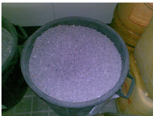
Figura 3.7- Agregados reciclados grossos BR1
