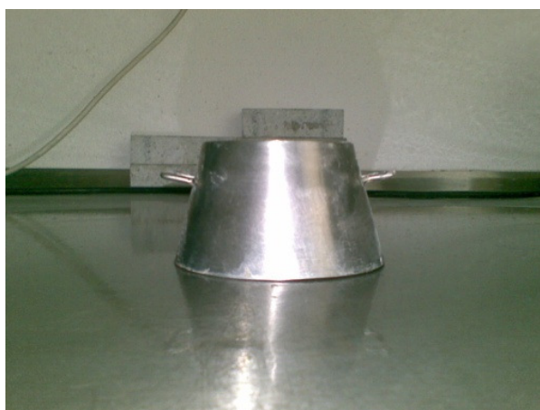
Figura 3.11- Cone de espalhamento das argamassas
