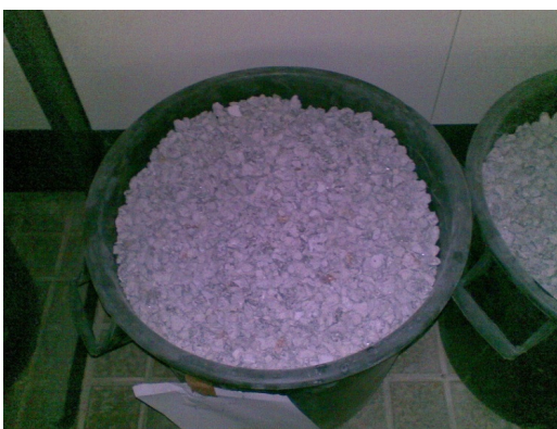
Figura 3.8- Agregados reciclados grossos BR2
