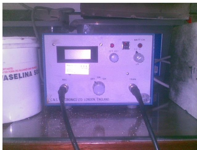
Figura 3.20- Aparelho de medição da velocidade de ultra-sons em betão
