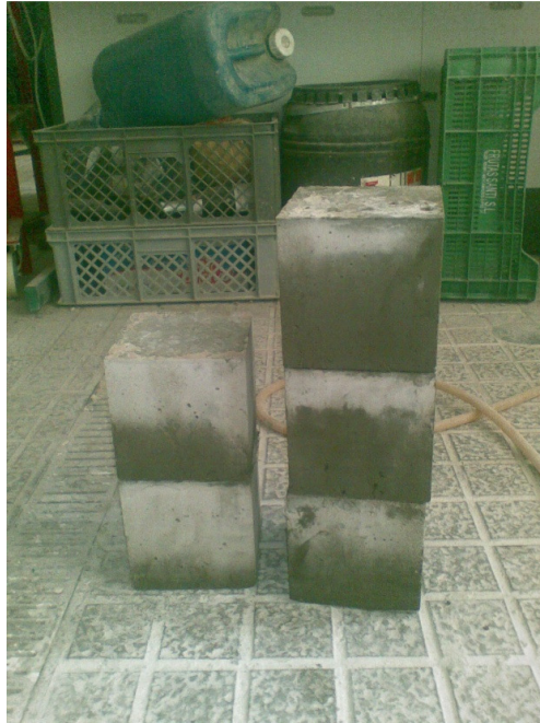
Figura 3.19- Provetes de betão
