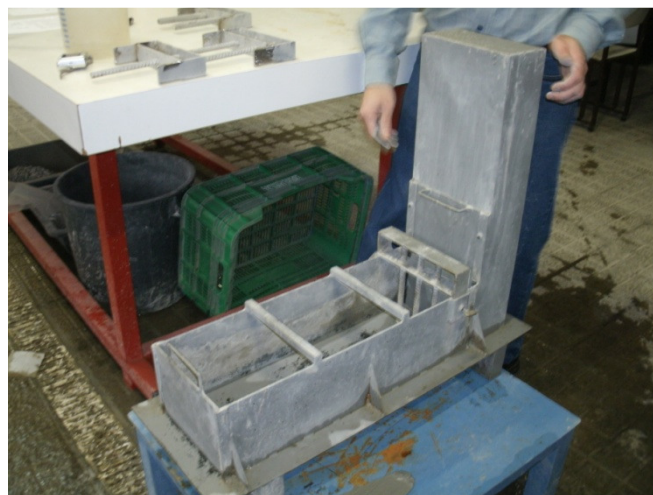
Figura 3.17- Enchimento da Caixa-L
