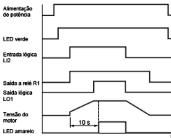
Figura 6.5 - Esquema temporal do comando a dois fios
