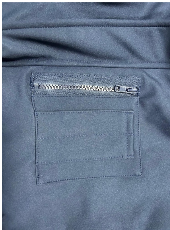
Figura 31. Controlo de qualidade, verificando costuras muito tortas (Fonte: Própria, 2024).
