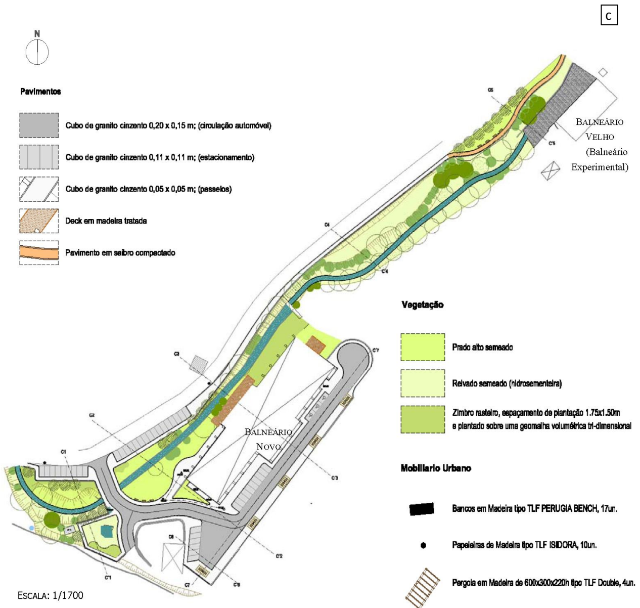
Figura 6.14 - Termas de Longroiva sustentadas no recurso água mineral sulfúrea: a) antigo balneário; b) novo balneário; c) enquadramento em planta dos balneários e arranjos paisagísticos (Ferreira Gomes et al. 2008),
