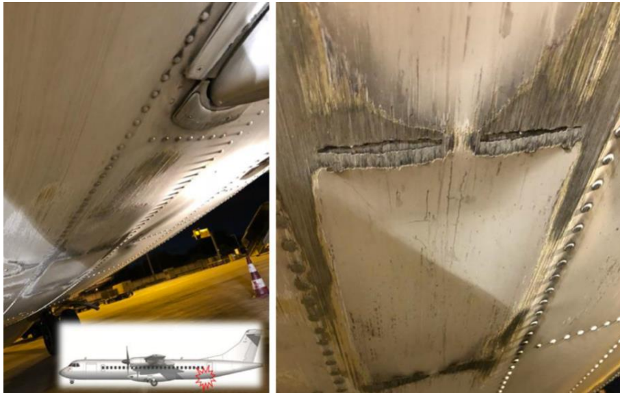
Figura 3. Danos na parte inferior traseira da fuselagem do ATR 72-212A (CS-DJG) [7].
