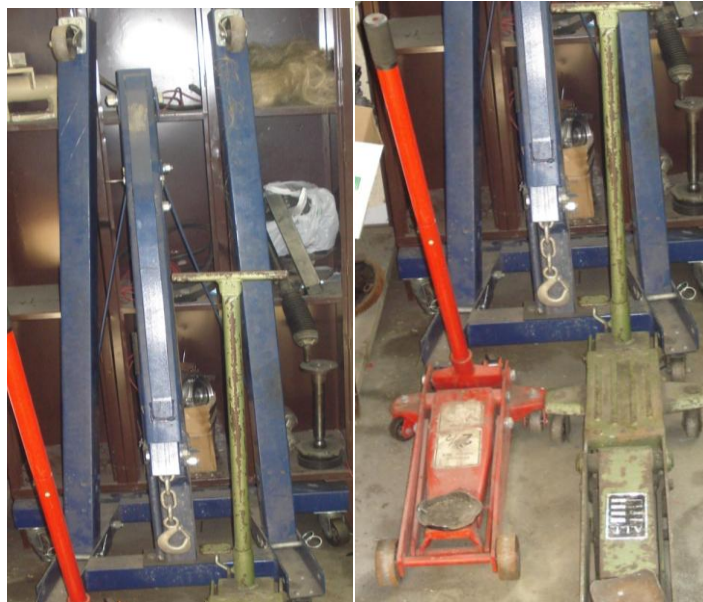
Figura 2.11 - Grua móvel e macacos horizontais de elevação
