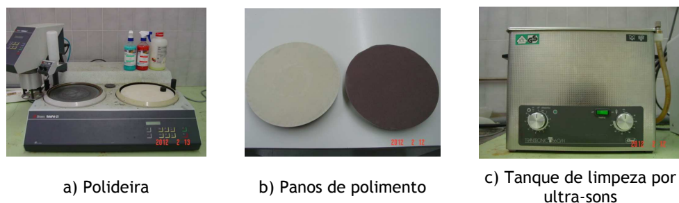
Figura 4.43 - Equipamento utilizado no polimento e na limpeza das amostras de pregos
