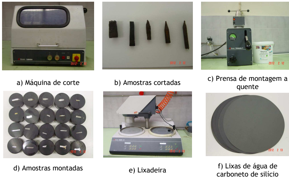
Figura 4.42 - Equipamento utilizado no corte, montagem e lixagem das amostras de pregos
