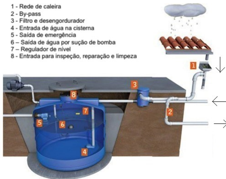
Figura 3.5 - Sistema de tratamento e armazenamento de águas pluviais (FazForte, 2021)
