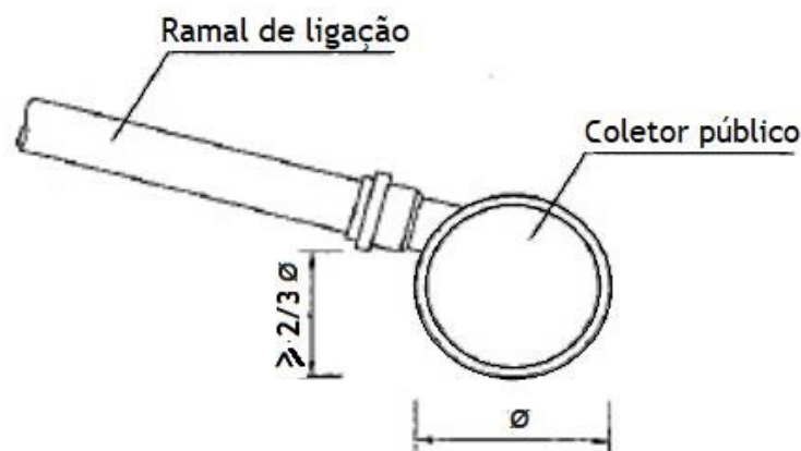
Figura 2.16 - Inserção direta do ramal de ligação no coletor publico (adaptada de Pedroso,2016).
