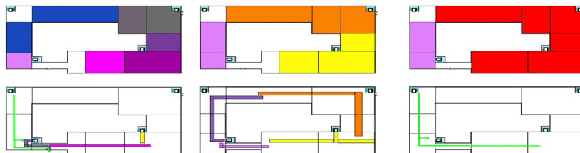
Figura 1 – Unidade de cuidados para o COVID-19. Zonamento e circuitos de funcionários, utentes e visitas (desenho de Jéssica Liane, 2020)
