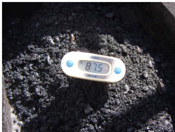
Figura 3. 7: Temperatura da mistura betuminosa reciclada no camião.
