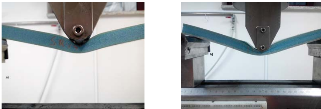
Figura 5.4: a) Falha do provete SPV por indentação b) Falha do provete DPV por instabilidade
