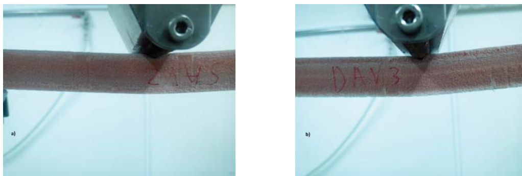
Figura 5.6: a) Falha do provete SAV por indentação b) Falha do provete DAV por indentação da primeira face
