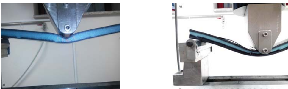
Figura 5.2: a) Falha do provete SPC por indentação b) Falha do provete DPC por instabilidade
