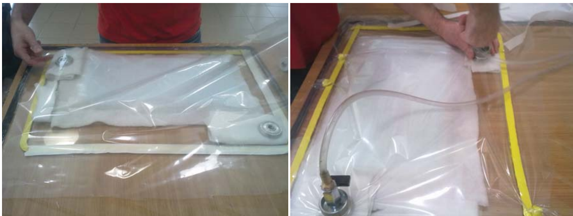
Figura 4.7: Placa de vidro empilhada e selada com saco de vácuo.
