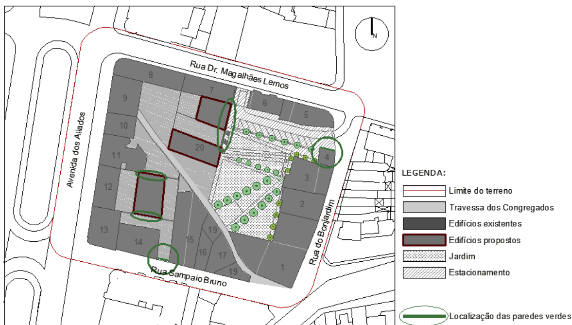
Figura 6.13 Planta síntese das paredes verdes.
