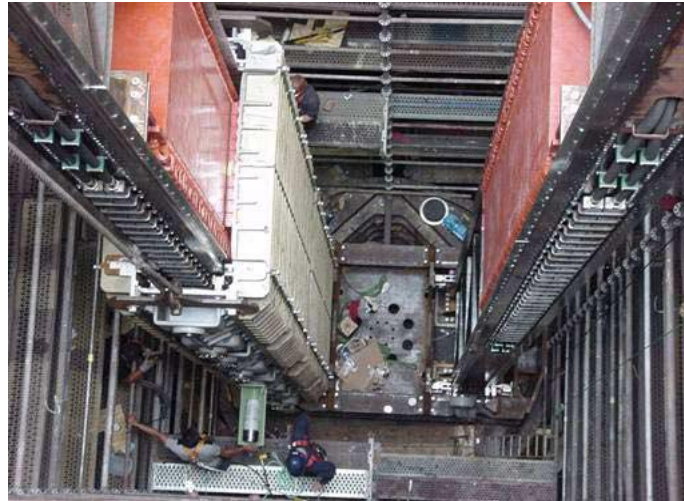
Fig. 3.19 Gerador linear de magnetos permanentes do sistema AWS [26].
