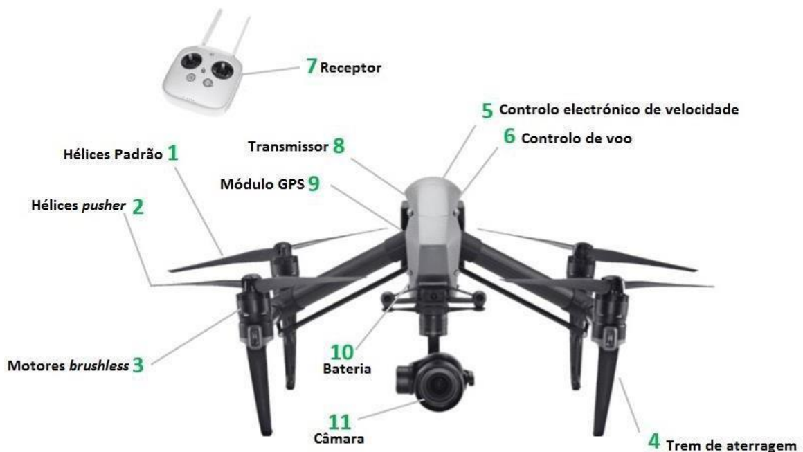
Figura 2.21: Componentes de um drone (ex. drone multi-rotor) (Adaptado de Grind Drone, 2021)
