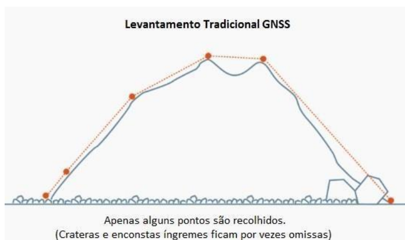
Figura 2.25: Levantamento tradicional GNSS (Adaptado de Wingtra, 2021)
