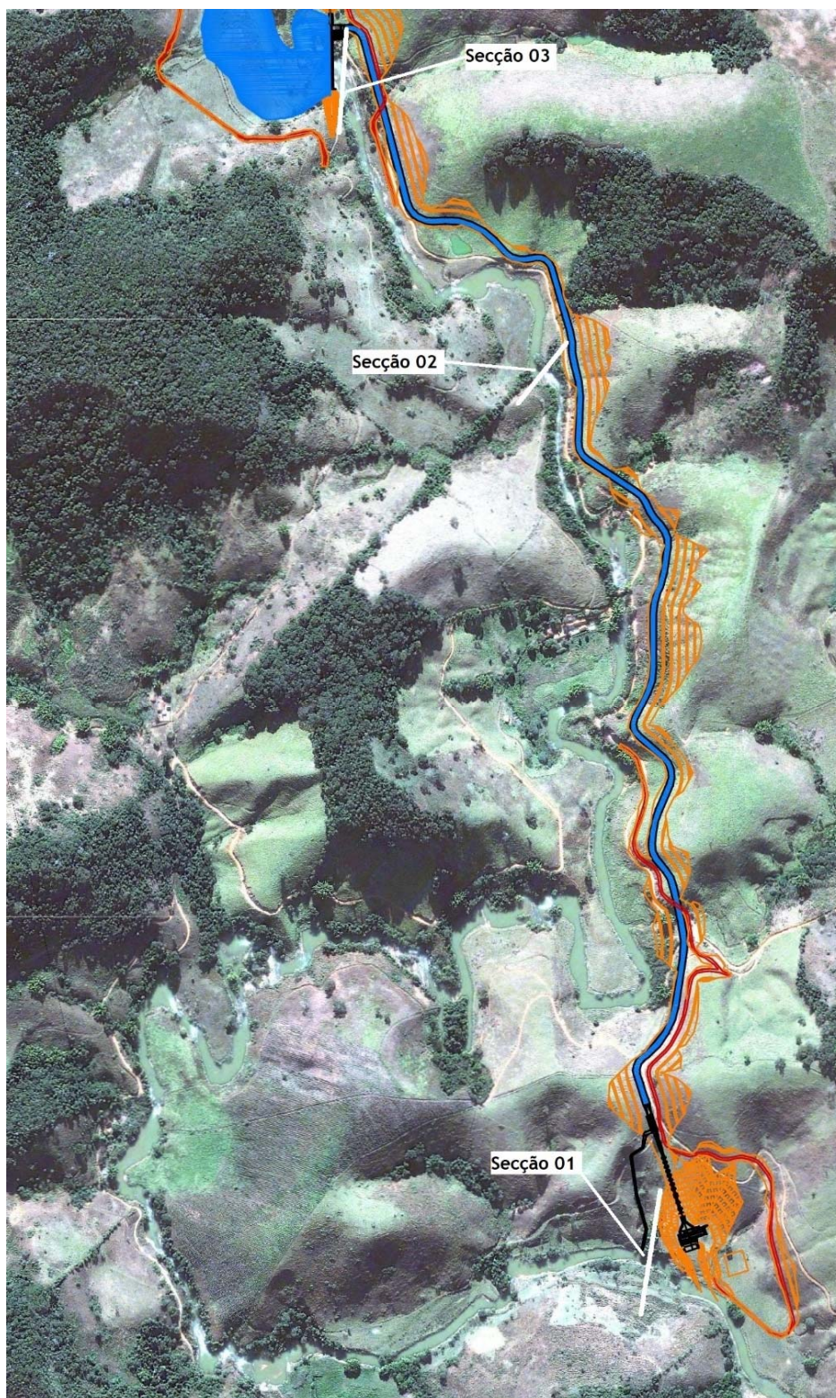
Figura 65 - Localização das secções utilizadas no método do perímetro molhado.
