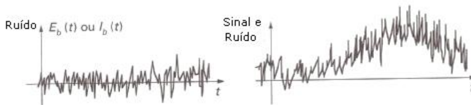
Figura 3.11 – Ruído de fundo: a) andamento da variação do ruído de uma tensão ou de uma corrente com o tempo; b) ruído sobreposto a um sinal.
