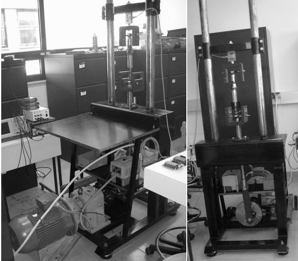
Figura 1.10 – Imagem da máquina de ensaio de amortecedores, após concluído o projecto e a sua construção.
