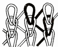
Figura 15: Esquema da formação das laçadas numa malha de trama. Fonte: Araújo, 1986.
