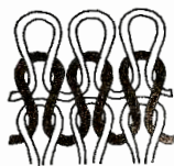
Figura 14: Esquema da formação das laçadas numa malha de trama. Fonte: Araújo, 1986.
