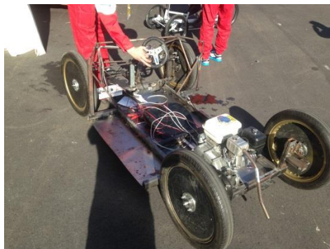
Figura 1.5 - Implementação do mecanismo de direção do triângulo sem correção no UBICAR
