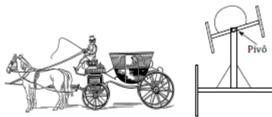
Figura 2.1 - Mecanismo de direção das carruagens primitivas [4].
