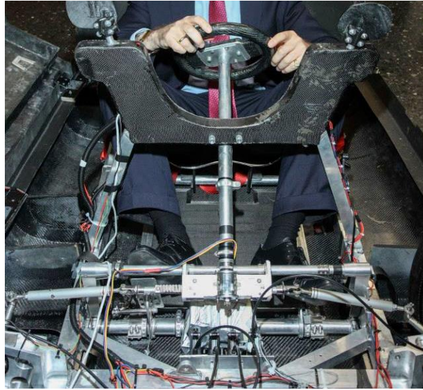
Figura 3.7 - Sistema de pinhão e cremalheira implementado no Skap 2 [20].
