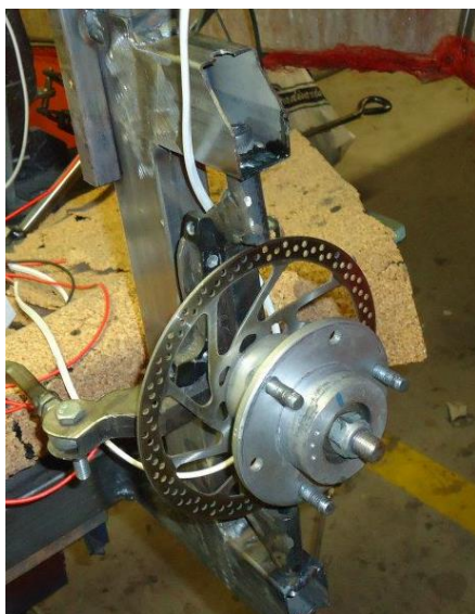
Figura 3.5 - Ilustração do ângulo do king pin , do camber e do caster do UBICAR.
