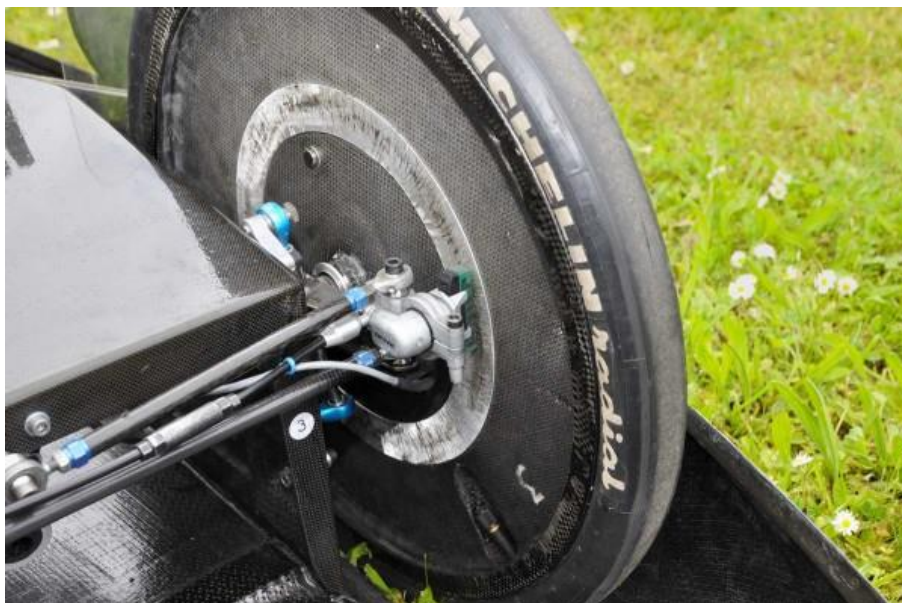
Figura 3.15 - Mecanismo de direção do Microjoule [26].
