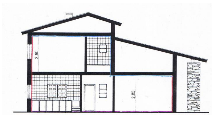
Figura 29 – Corte, projecto de arquitectura do Edifício G
