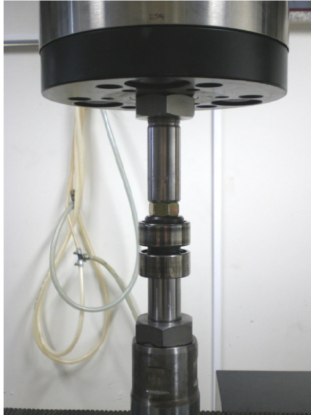
Figura 4.2 - Fixação da amostra para realização do ensaio na máquina INSTRON.
