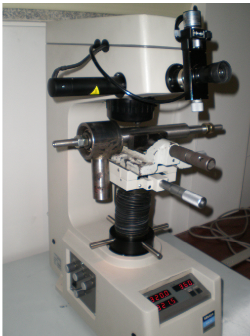
Figura 3.3 - Realização do ensaio de dureza
