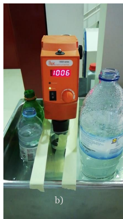
Figura 3.4 - Mistura no a) banho de ultrassom b) com o misturador mecânico e com garrafas de gelo.
