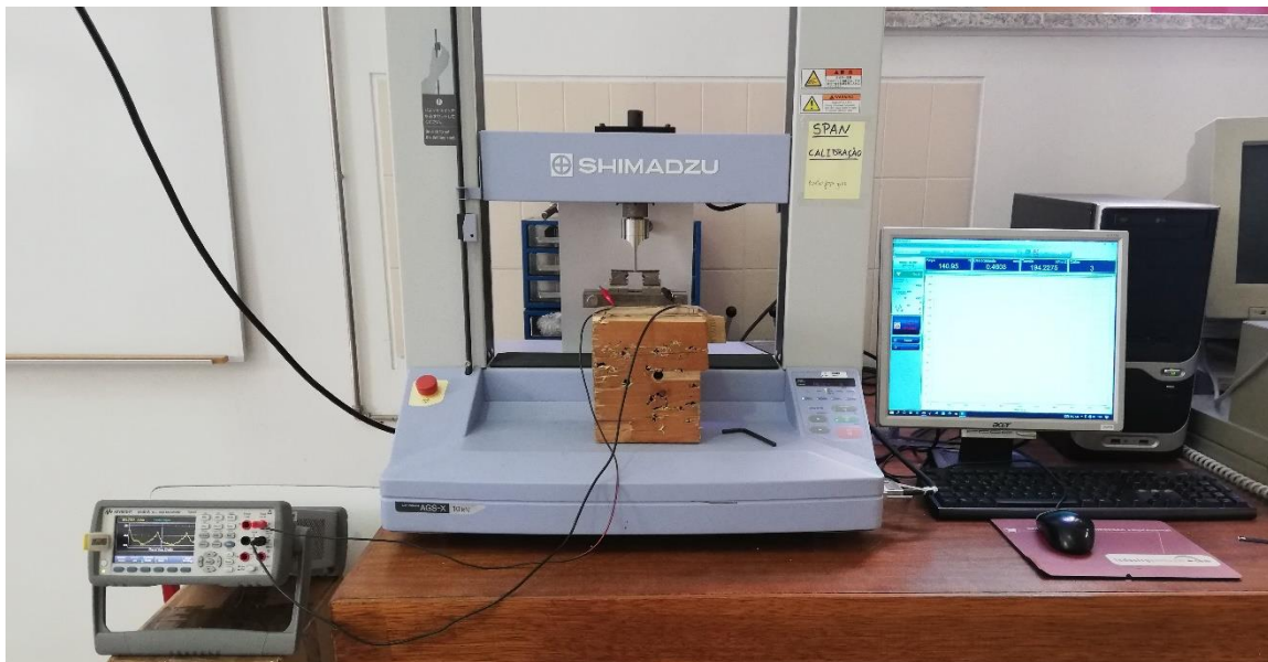
Figura 3.29 - Montagem dos equipamentos para os testes de piezoresistividade.
