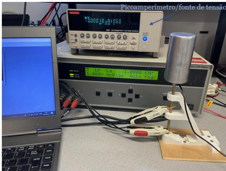
Figura 3.27 – Setup experimental para medição da resistividade.
