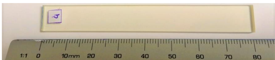
Figura 3.3 - Provette padrão de resina epóxi, sem reforço.
