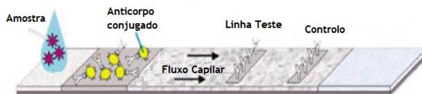
Figura 23. Princípio do teste imunocromatográfico (adaptado de Sebastian C. et al. , 2016) 46 .
