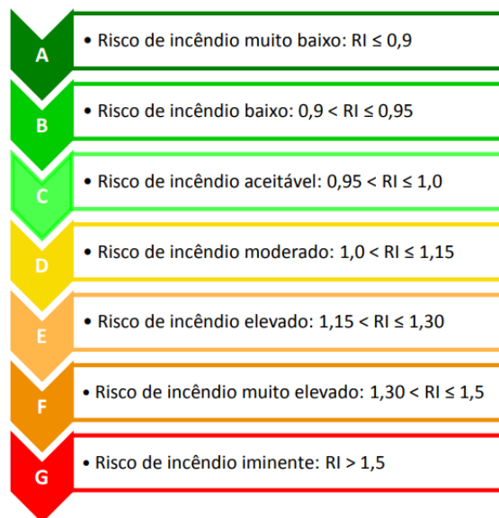
Figura 2. 3 - Classificação do edificado de acordo com o risco de incêndio - Método MARIEE
