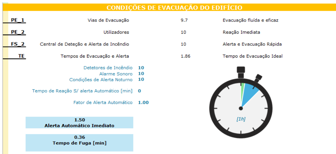
Figura 4. 44 - Resumo das Condições de Evacuação - Certificado SCI
