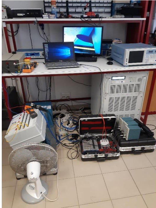
Figura 34 - Bancada de simulação das avarias de curtos-circuitos entre espiras no motor e desequilíbrios de fase e amplitude na rede de alimentação.
