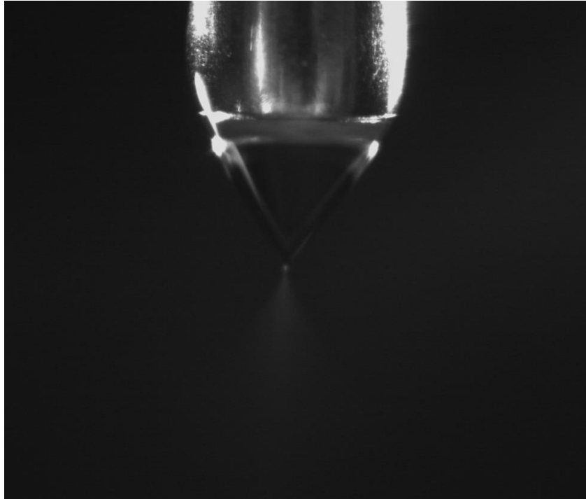
Figura 5.5: “Cone-jet” de etanol observado com uma ampliação de cerca de 250x.
