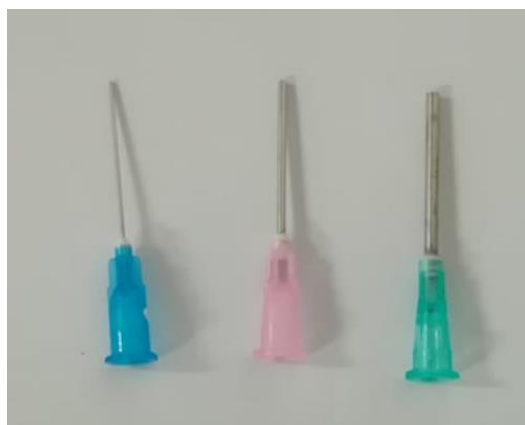
Figura 4.7: Agulhas utilizadas com diâmetros externos de 0,6mm (esquerda), 1,1mm (centro) e 2,1mm (direita).
