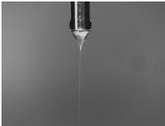
Figura 5.6: Etilenoglicol a 2,5237 mL/hr, 4,65 kV, L=0,9 cm, D_e=1,1 mm.
