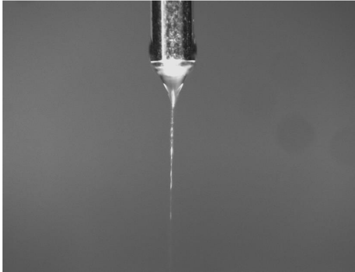
Figura 5.7: Etilenoglicol a 2,5237 mL/hr, 4,70 kV, L=1,2 cm, D_e=1,1 mm.
