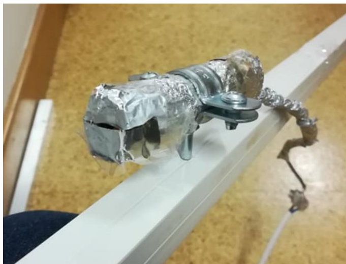
Figura 4.12: Laser utilizado, coberto de forma a reduzir o ângulo da folha de luz emitida.
