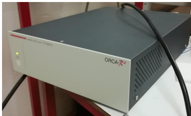
Figura 4.11: Unidade de controlo da câmara.
