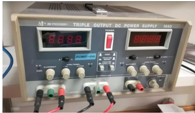
Figura 4.6: Fonte de tensão DC utilizada para o motor e microcontrolador do laser.
