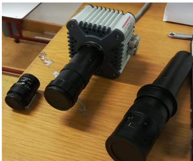
Figura 4.10: Câmera utilizada e as 3 lentes com magnificação máxima de 5x (esquerda), 100x (centro) e 300x (direita).
