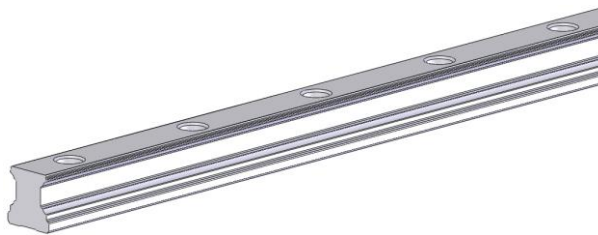
Figura 4.6 Detalhe da barra em aço inoxidável revestida a crómio que constitui o carril-guia para movimento das plataformas do actuador (perspectiva dimétrica).
