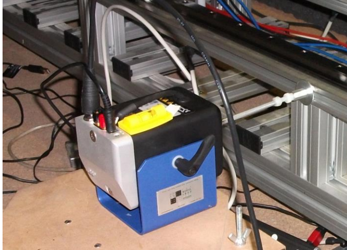
Figura 6.6 Pormenor do shaker electrodinâmico montado na base e acoplado à estrutura do ALRVC.
