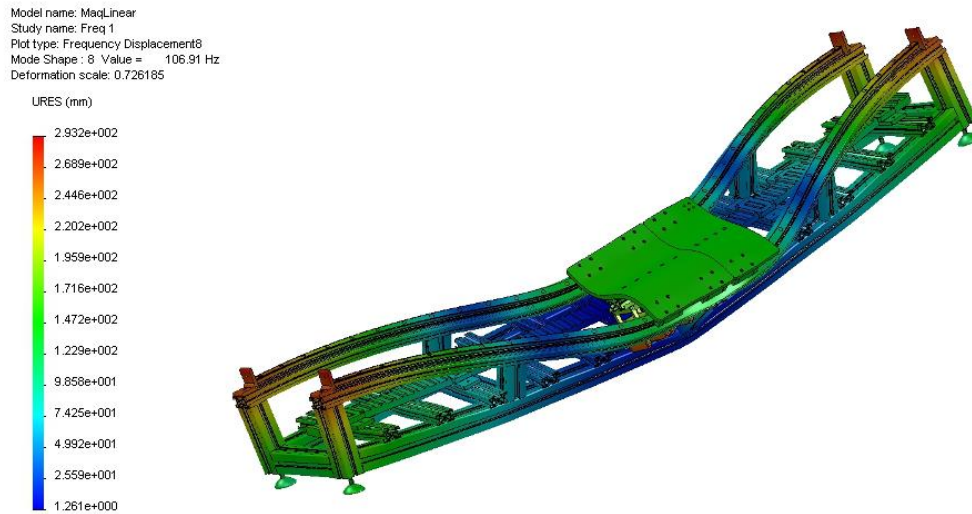
Figura 4.24 Forma modal para o modo de vibração #8-P3 ( f=107 Hz).
