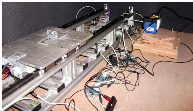
Figura 6.8 Aspecto do banco de ensaios na fase de instalação do shaker e colocação dos acelerómetros.
