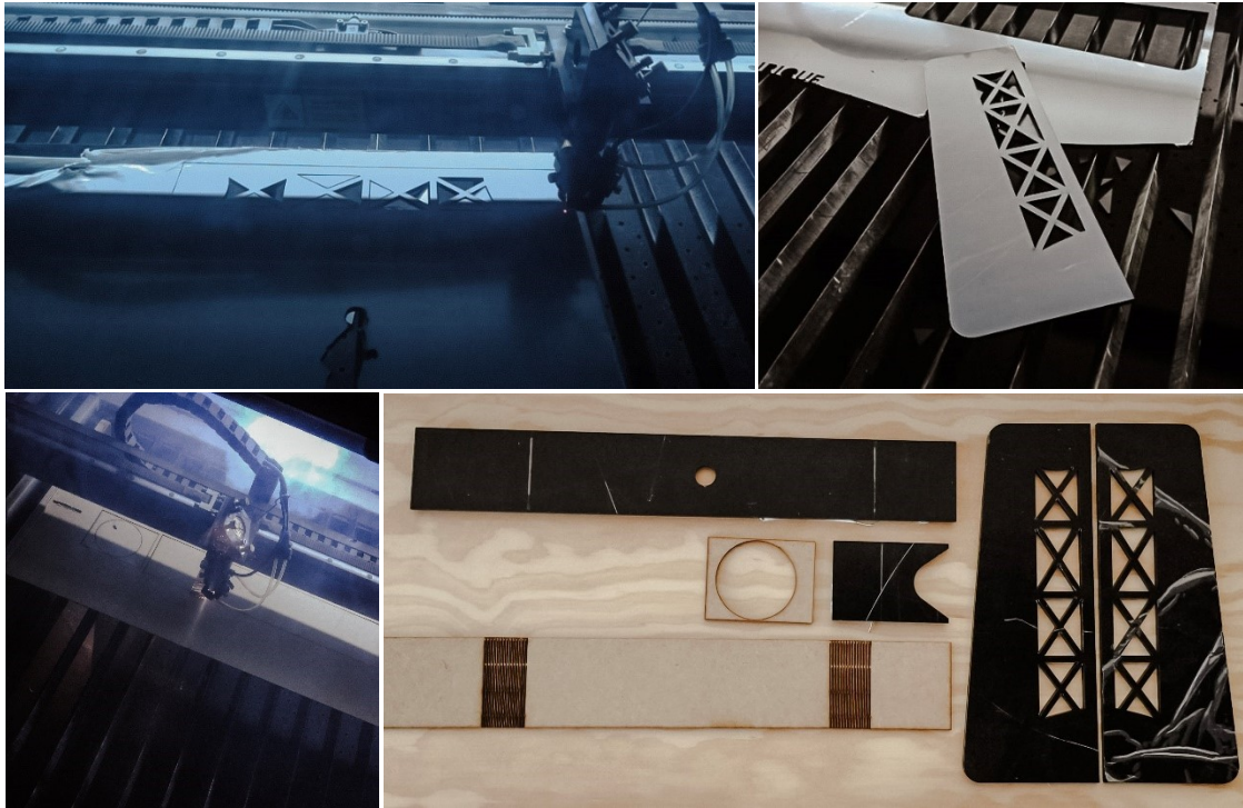
Figura 64: Corte de peças (PETG 5mm/Mdf 3mm)
