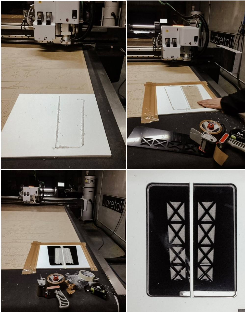
Figura 65: Processo de rebaixamento de parte frontal/traseira 2mmx4mm Esko kongsberg
