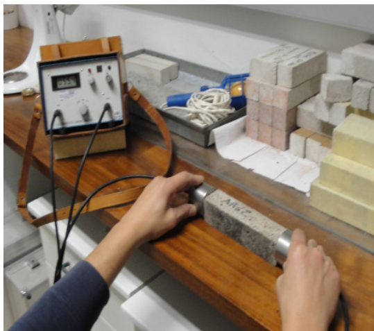
Figura 9 - Aparelho de ultra-sons Pundit
