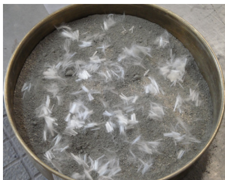
Figura 33 - Adição das fibras acrílicas à matriz cimentícia
