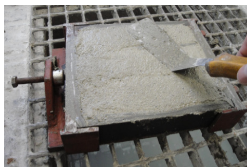
Figura 36 - Extração dos excessos de argamassa nos moldes
