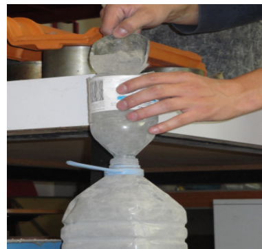
Figura 34 - Colocação da matriz cimentícia fibrosa no garrafão
