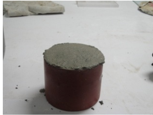
Figura 44 - Argamassa depois do ensaio da massa volúmica em pasta
