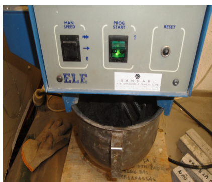
Figura 31 - Amassadura da argamassa
