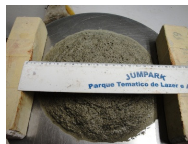
Figura 42 - Medição do espalhamento da argamassa
