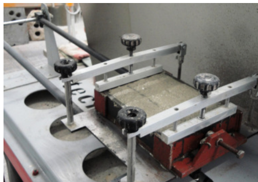
Figura 37 - Compactação da argamassa
