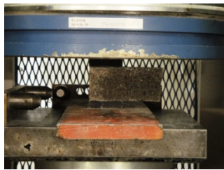
Figura 54 - Ruptura do provete
