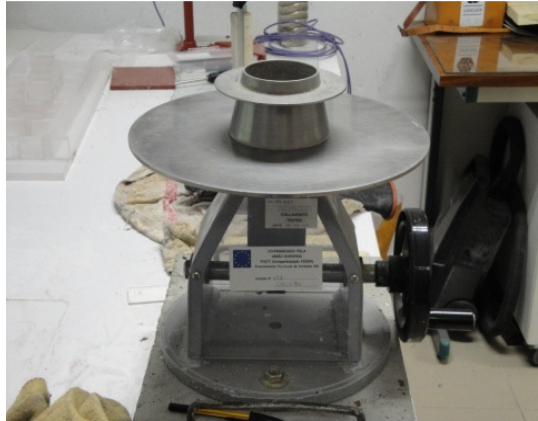
Figura 2 - Aparelho manual para o teste de consistência por espalhamento (Flow Table)
