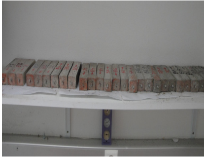
Figura 62 - Provetes na sala de cura
