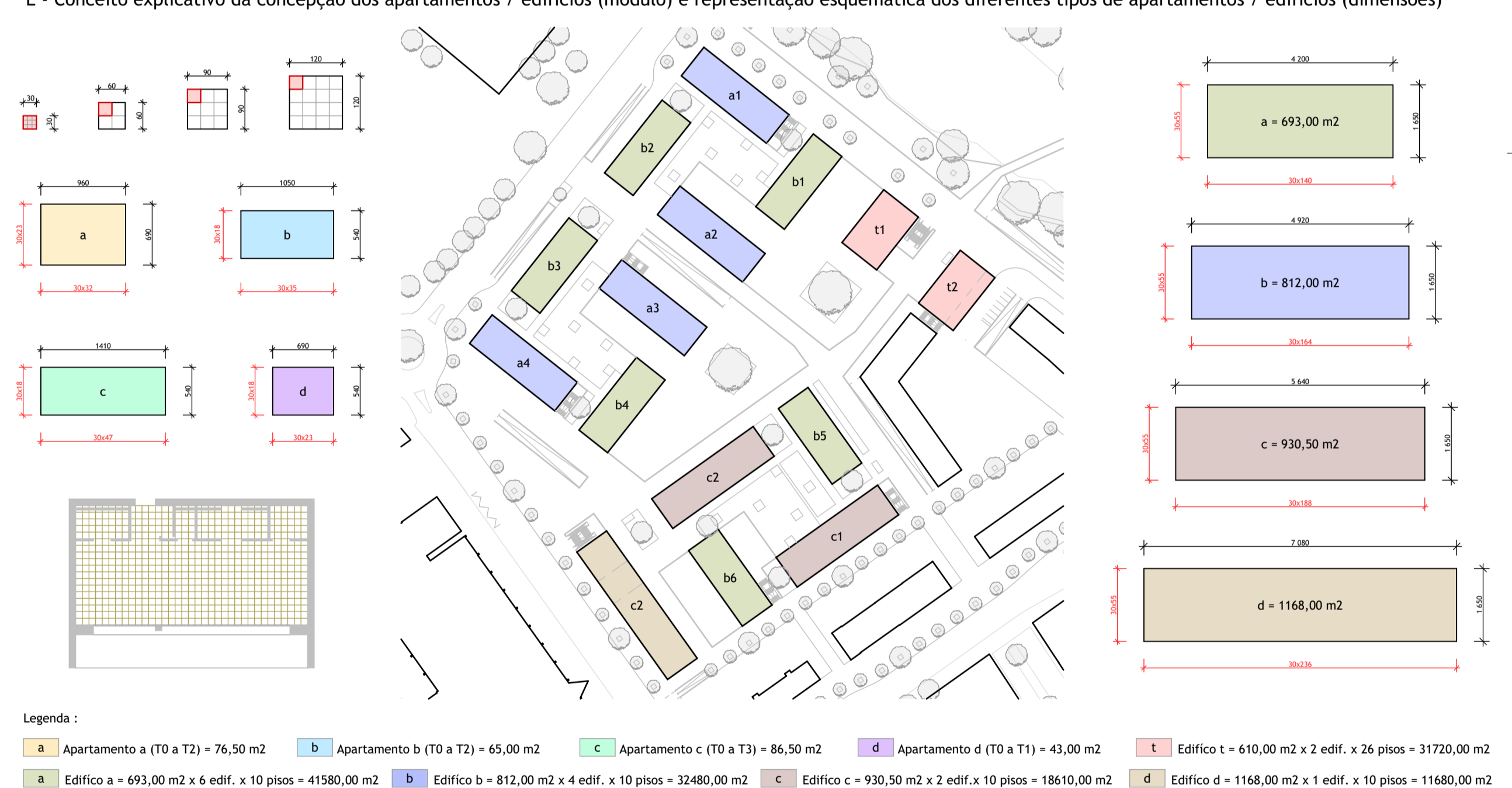
Fig. 11 - Conceito explicativo da concepção dos apartamentos / edifícios (módulo) e representação esquemática dos diferentes tipos de apartamentos / edifícios (dimensões)
