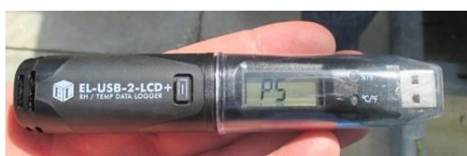
Figura 27 - Exemplo do analisador utilizado nas medições de temperatura do interior do armário.
