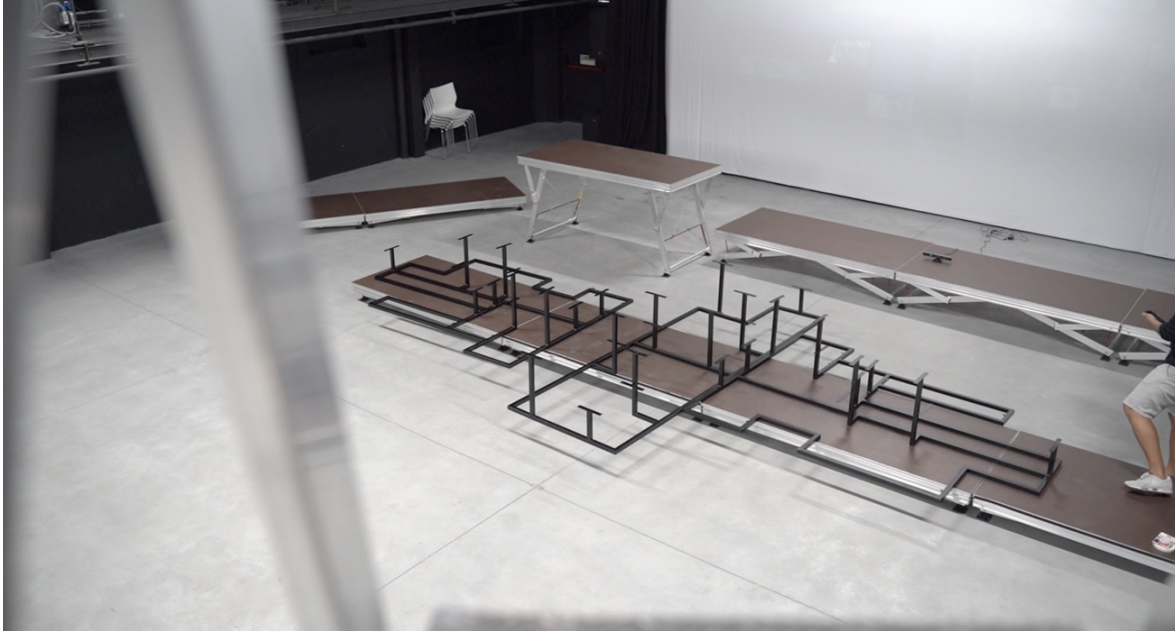
Figura 56 Estrutura base dividida em três partes para facilitar o transporte
