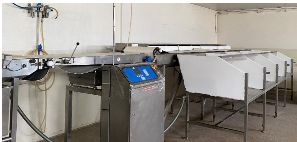
Figura 50 - Máquina que classifica o produto por tamanho e peso
