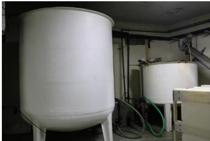
Figura 43 - Tanque que faz a mistura da salmoura
