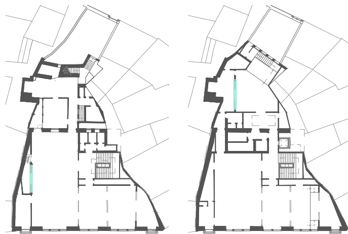
Imagem 247 e 248 - Localização do Arco V8 na planta original (esquerda) e na planta de projeto (direita) - Escala 1:650
