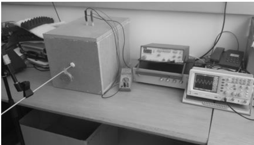
Figura 6.7 - Sistema de teste constituído por um osciloscópio, gerador de sinais, amplificador, e coluna.
