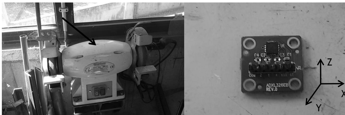
Figura 2.11 - Medição e caracterizam das vibrações numa esmeriladora.
