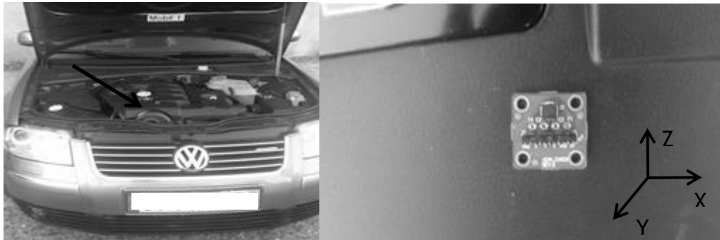
Figura 2.7 - Medição e caracterizam das vibrações num automóvel.
