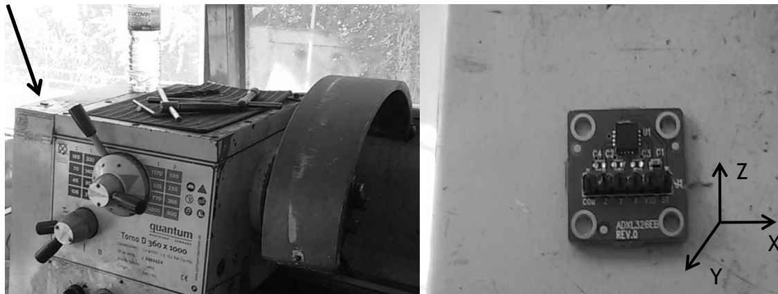
Figura 2.19 - Medição e caracterizam das vibrações num torno.
