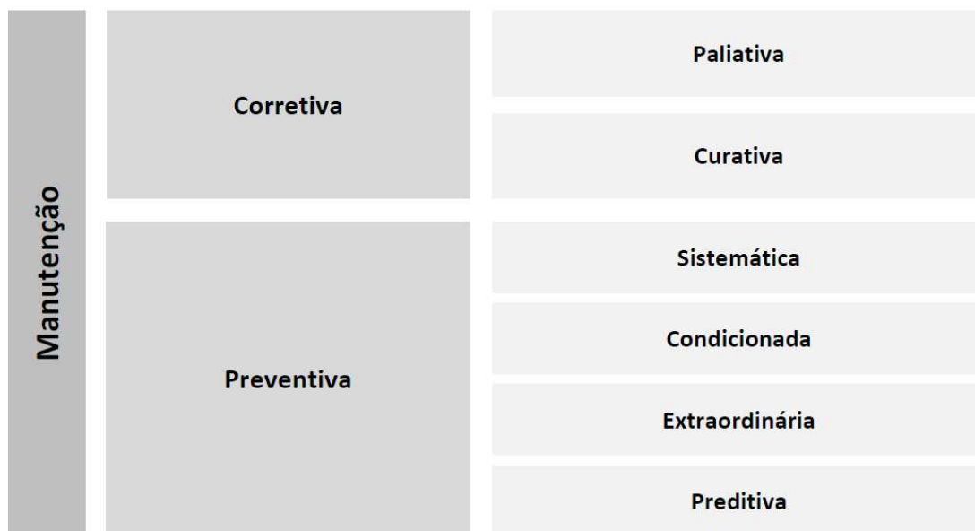
Figura 8 - Tipos de Manutenção adotados pela EDPD.
