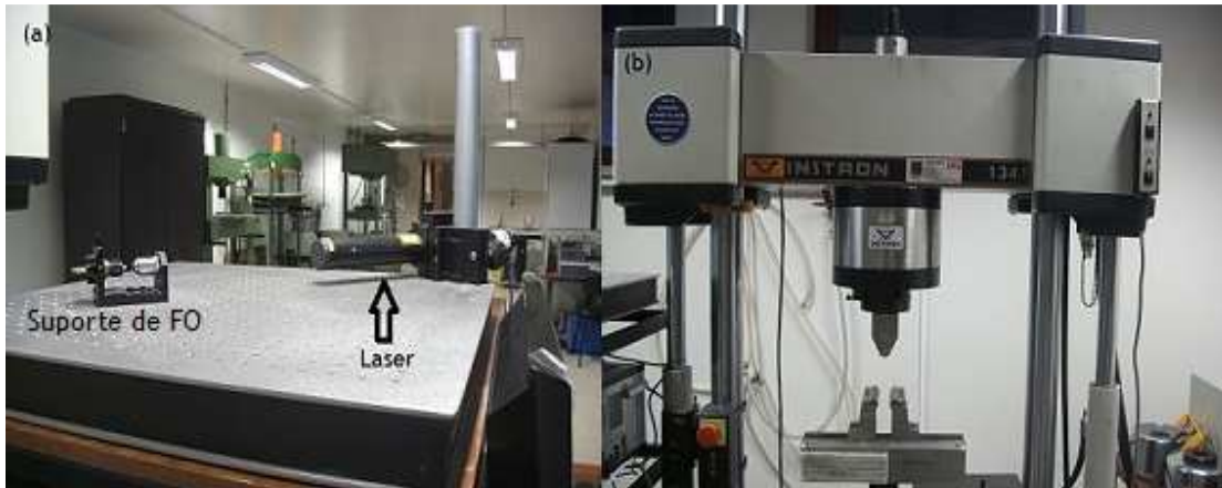
Figura 16 - Laser utilizado para produção do sinal luminoso (a) e máquinas de ensaios Instron (b)
