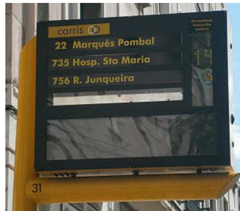
Fig. 3.7 - Painel de informação em tempo real na paragem com previsão do tempo de espera da Carris Fonte: IMTT, 2011a
