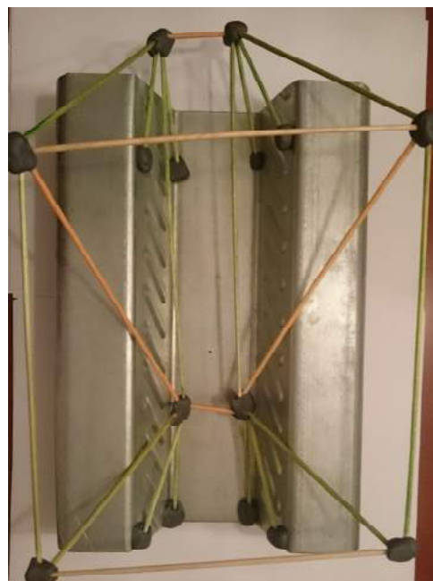
Figura 69 - Modelo físico de escoras e tirantes
