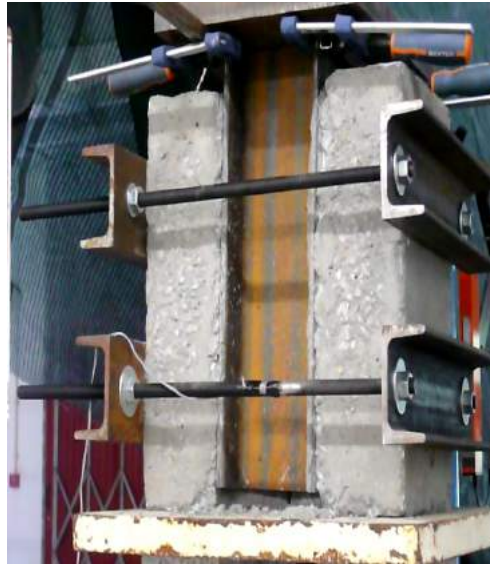
Figura 102 - Corpo de prova após rotura (372 kN \delta=5,85\text{mm} ) - CP.3.NSP
