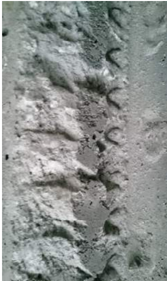
Figura 105 - Interface no betão - CP.3.NSP após rotura
