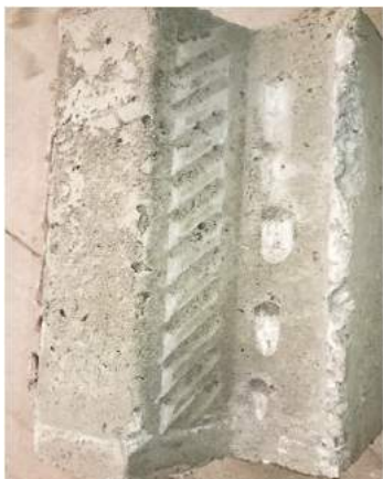
Figura 96 - Interface no betão - CP.1.H60 após rotura
