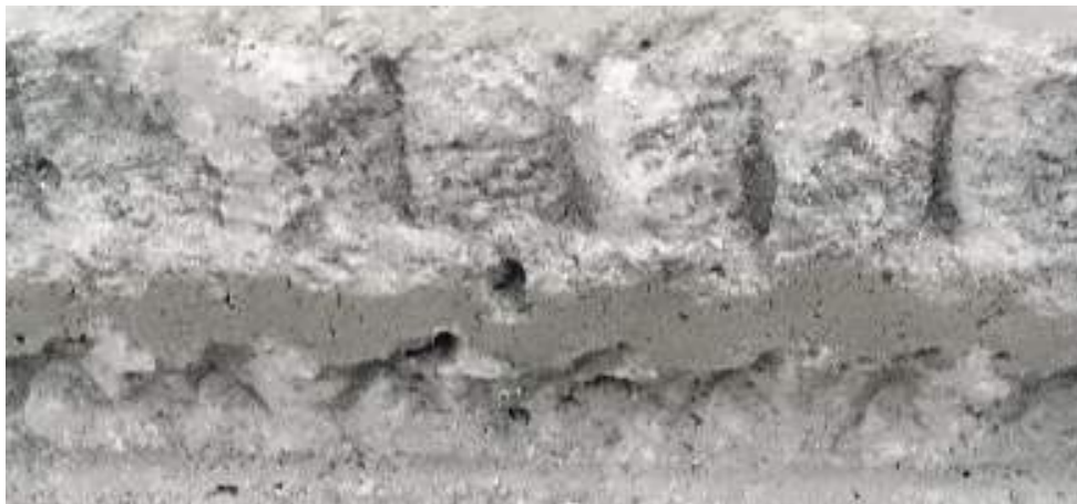
Figura 106 - Esmagamento do betão na interface (betão) - CP.4.NSP
