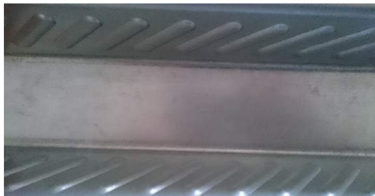
Figura 77 - Distribuição antissimétrica de bossas - chapa perfilada H60
