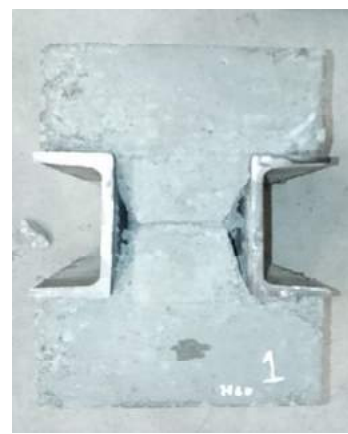
Figura 97 - Vista superior - CP.1.H60 após rotura
