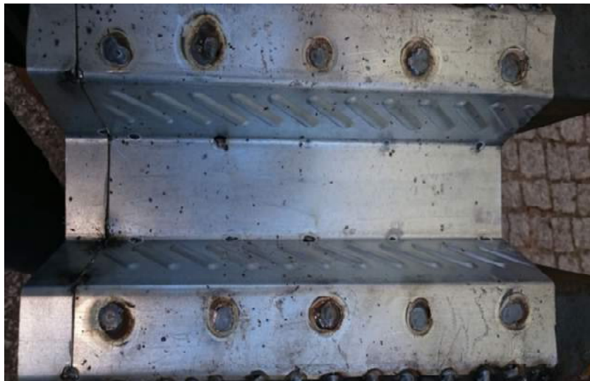
Figura 81 - Corpos de prova após construção da parte metálica
