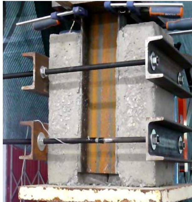
Figura 101 - Primeira fissura (50 kN \delta=1,18\text{mm} ) - CP.3.NSP
