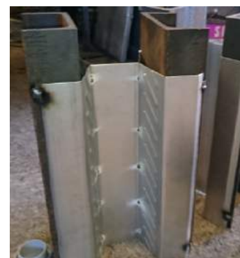
Figura 80 - Soldadura dos corpos de prova para a secção H60
