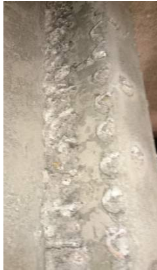
Figura 104 - Interface no aço - CP.3.NSP após rotura
