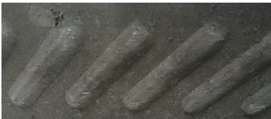
Figura 99 - Face da chapa após rotura - CP.2.H60
