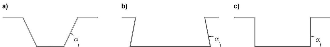
Figura 3 - Inclinação de almas das secções tipo
