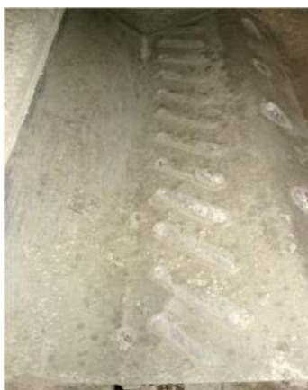
Figura 95 - Interface no aço - CP.1.H60 após rotura
