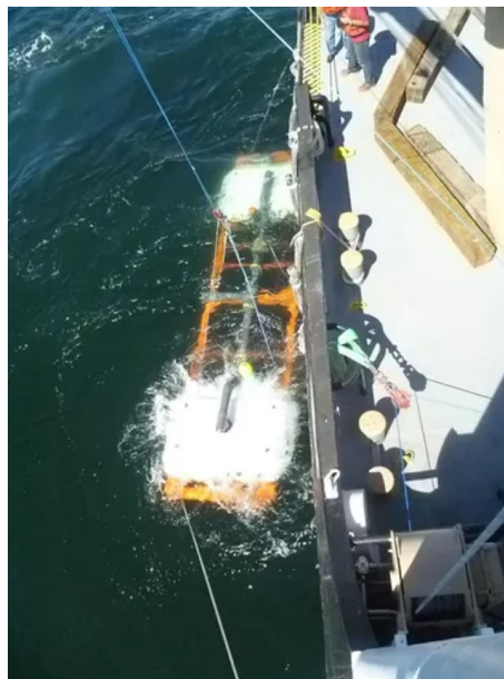
Figura 2.22: Modelo do dispositivo M3Wave DMP durante o seu lançamento para testes ao largo da costa de Oregon, nos Estados Unidos da América.
