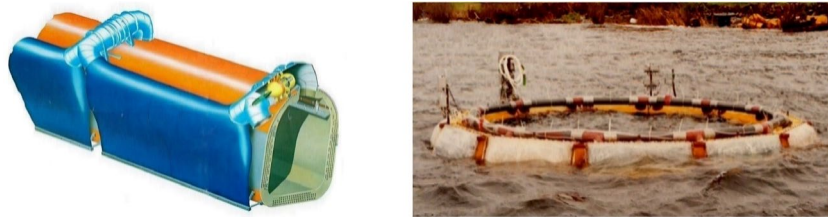
Figura 2.6: Dispositivo SEA-Clam linear (esquerda) e dispositivo SEA-Clam circular (direita).
