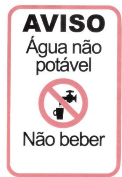
Figura 2.17 - Modelo de aviso a colocar junto de dispositivos de rega ou lavagem alimentados por água da chuva (ANQIP, 2022)
