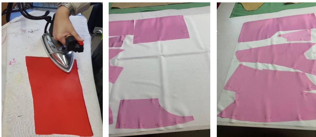
Figura 29 Colocação de entretelas (Autor).
