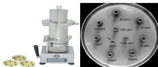
Figura 2.17 - Na esquerda, dispensador e placas dispensadas, na direita um exemplo de ensaio com halos de inibição [consultado em http://www.tsh.co.in/EqGen.html ; Ahmed A. et al , 2012]
