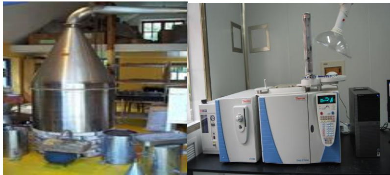
Figura 3.1 - Na esquerda extracção de óleos essenciais por arraste de vapor, na direita GC-MS [Adaptado de: http://aromalandia.com.br/extracao/html ; http://english.qibebt.cas.cn/rs/fs/ ].
