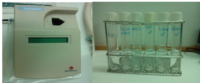
Figura 3.5 - Na esquerda fotómetro de medição da turvação pela escala McFarland para padronização de inóculos; na direita tubos com suspensões bacterianas.
