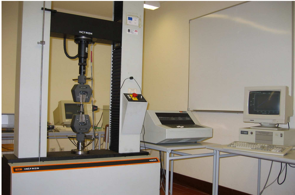
Figura 3.3 - Máquina electromecânica, Instron modelo 4206, utilizada nos ensaios de tracção.
